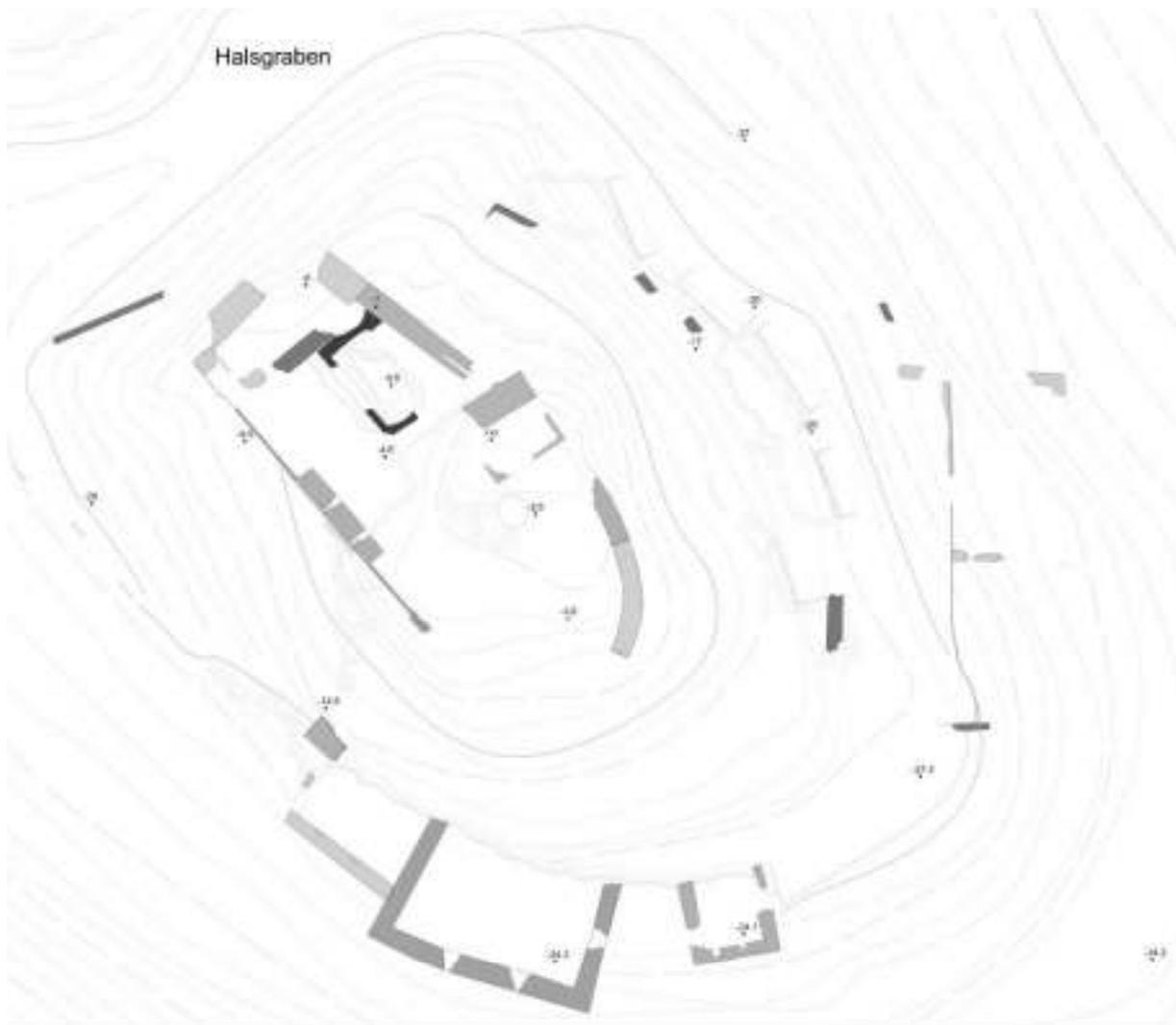
Abb. 9: Burg Waldeck, Grundriss der Gesamtanlage mit farblicher Differenzierung (Graustufen) der einzelnen Bauabschnitte. Mangels absolut datierter Bauteile ist die Chronologie relativ (älter=dunkel nach hell=jünger)
